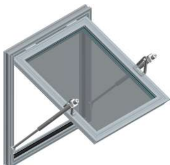
Rys. 89 Okno oddymiające mcr OSO THERM 75 z dwoma siłownikami wrzecionowymi S z przesuniętym punktem obrotu
